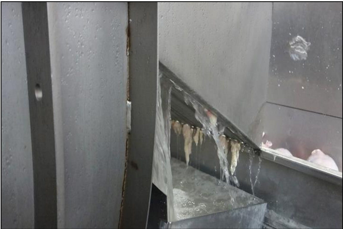
圖二、冷卻槽水需充分溢流，不得形成血紅色。
