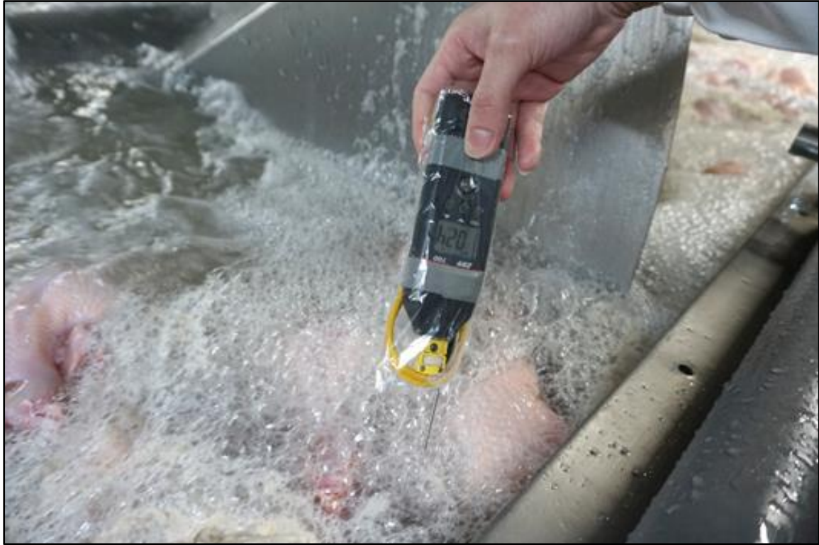
圖三、屠宰作業中需定時監測冷卻槽內水溫度、顏色、氯濃度及屠體中心溫度並記錄。
